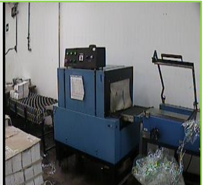
Túnel de secado: No existe homogeneidad de temperatura, deficiencia térmica
